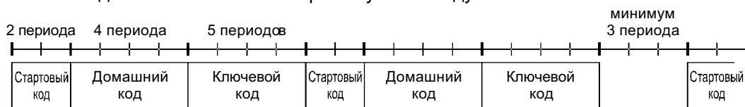
Технология X-10: принцип передачи кода
